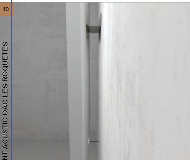
10 - Coloque su absorbente mural Rockfon Eclipse en el perfil de fijación de la pared y ajuste el espaciador hasta que el panel de pared Rockfon Eclipse esté nivelado.
