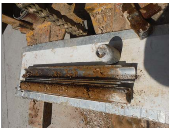
Foto 5: Sondeig S-1, SPT a 5,8 metres.
