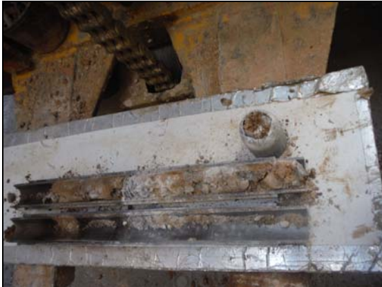
Foto 7: Sondage S-2, SPT a 1,5 metres.
