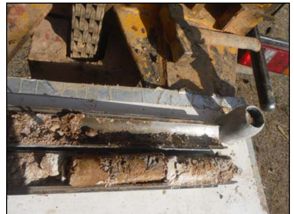
Foto 10: Sondage S-3, SPT a 1,6 metres.
