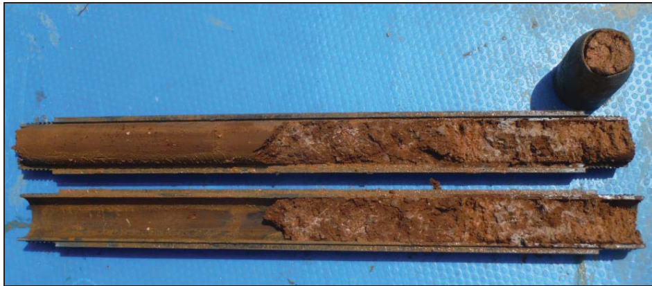
Mostra de la capa B, a l'assaig SPT.
