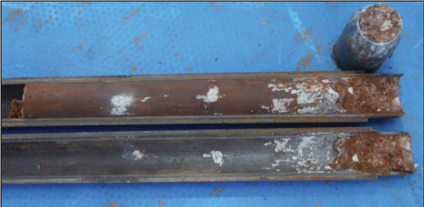
Mostra de la capa B, a l'assaig SPT.
