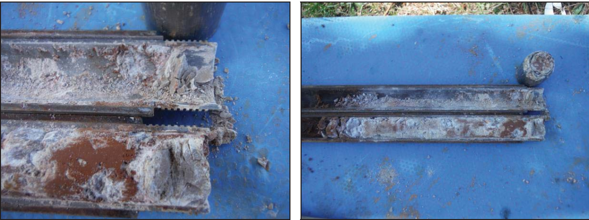
Mostres de la capa C, als assaigs SPT.
