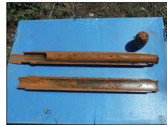
Foto 23: Sondeig S-3, SPT a 5,4 metres.
