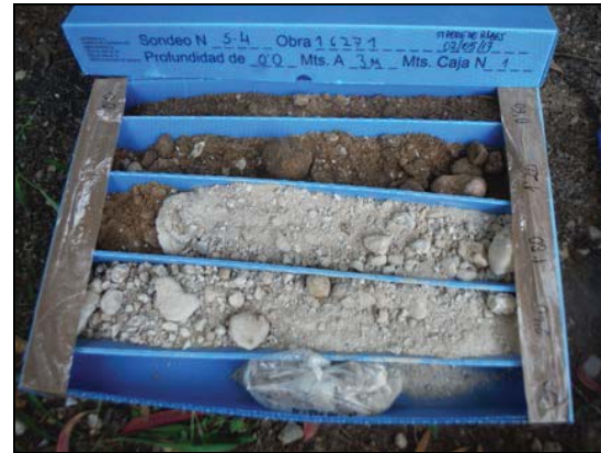
Foto 26: Sondeig S-4, caixa de 0 a 3 metres
