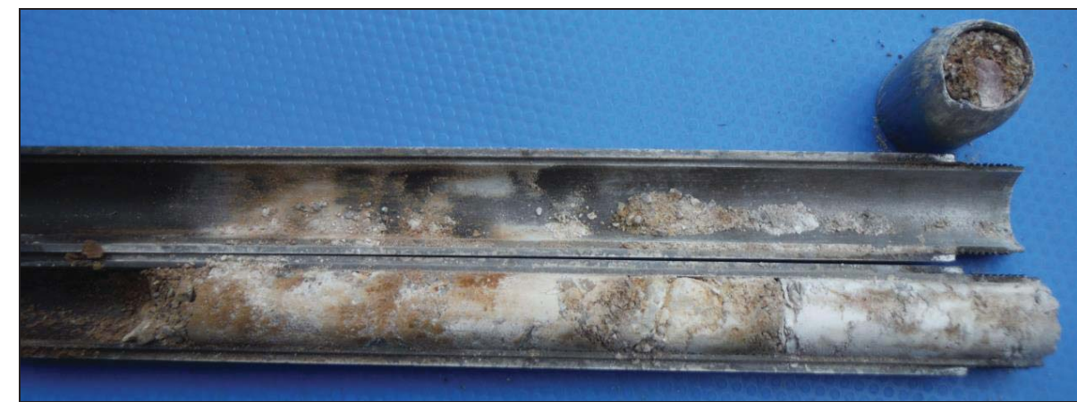
Mostra de la capa A, a l'assaig SPT.
