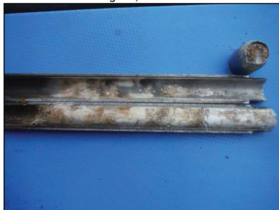
Foto 29: Sondeig S-4, SPT a 2,4 metres.
