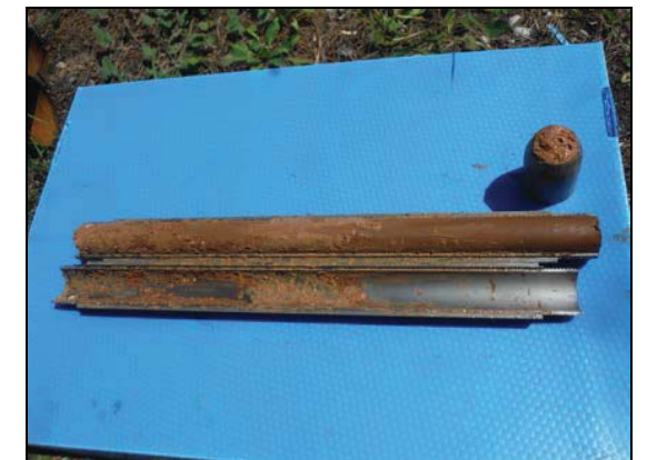
Foto 22: Sondeig S-3, SPT a 3,0 metres.
