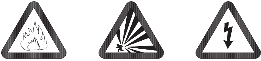
RISC D'INCENDI RISC D'EXPLOCIÓ RISC ELÈCTRIC
