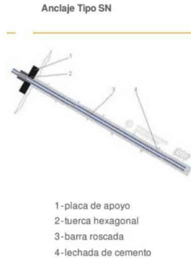
Figura 1: Esquema d'ancoratge Gewi tipus SN
