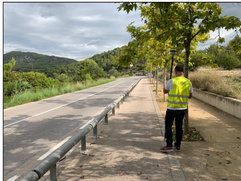
Figura 1: Presa de dades altimètriques realitzada amb l'aparell Trimble R2
