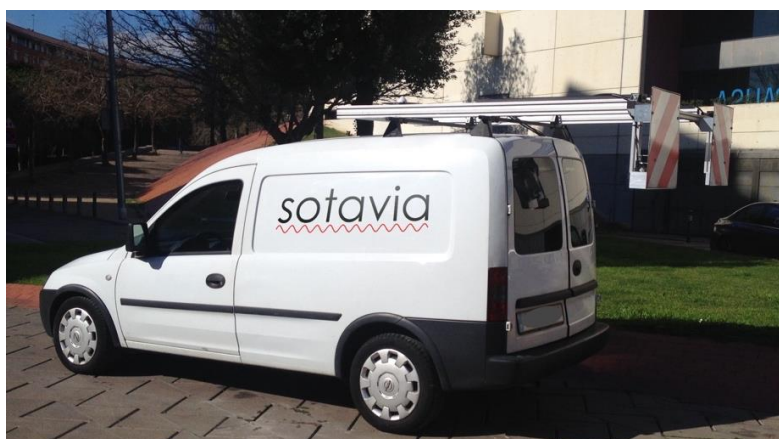
Figura 1: Vehicle detector de desperfectes amb les càmeres a la part posterior
