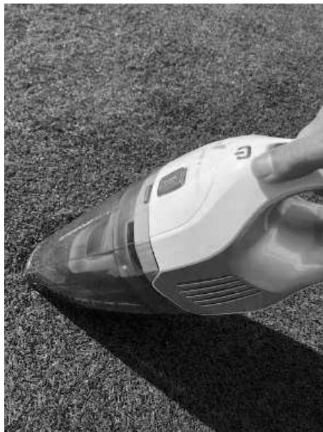
Presa de mostres i recollida de farcits existents per analitzar i punxades al paviment per saber quantitat de reblert que hi ha en aquests moments a la gespa. S'ha observat que la mitjana de reblert existent és d'aproximadament 25mm.
