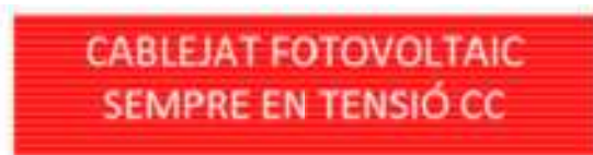
Figura 14. Senyalització cablejat CC. Font: Bombers de Barcelona.
