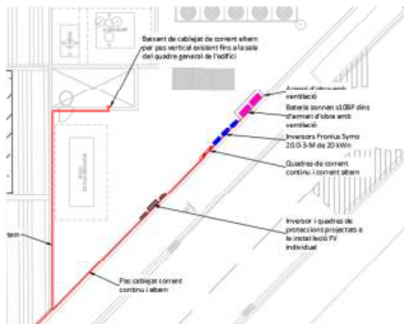
Figura 11. Espai reservat per a instal·lar els inversors solars, bateria i els quadres elèctrics de protecció de la instal·lació fotovoltaica. Font: Elaboració pròpia.
