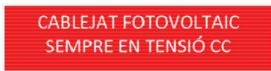
Figura 14. Senyalització cablejat CC. Font: Bombers de Barcelona.
