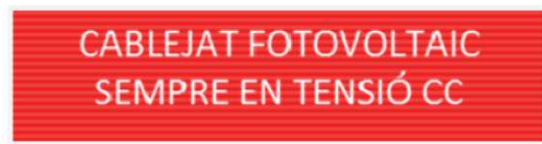
Figura 14. Senyalització cablejat CC. Font: Bombers de Barcelona.
