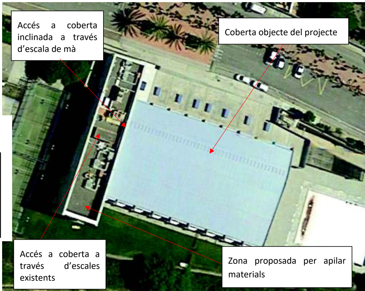
Figura 2. Emplaçament de l'accés a coberta i de la coberta objecte del projecte. Font: Elaboració pròpia.
