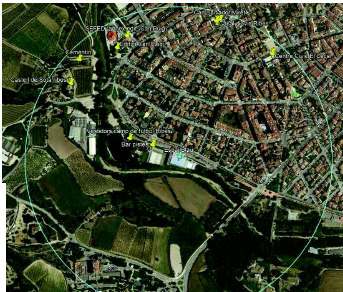
Figura 18. Consums associats a l'autoconsum col·lectiu de la instal·lació plantejada on es marca el límit de 500 metres. Font: Google Earth.
