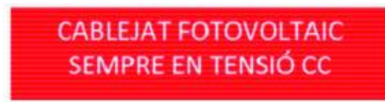
Figura 14. Senyalització cablejat CC. Font: Bombers de Barcelona.
