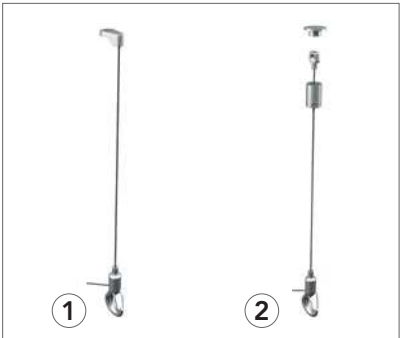
Rockfon tiene dos juegos de suspensión diferentes con un cable metálico ajustable de 1500 mm y un gancho de sujeción de seguridad. 1. Solución clásica 2. Solución estética
