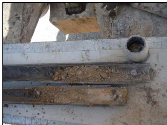
Foto 4: Sondeig S-1, SPT a 2,6 metres.
