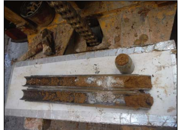
Foto 8: Sondeig S-2, SPT a 4,2 metres.
