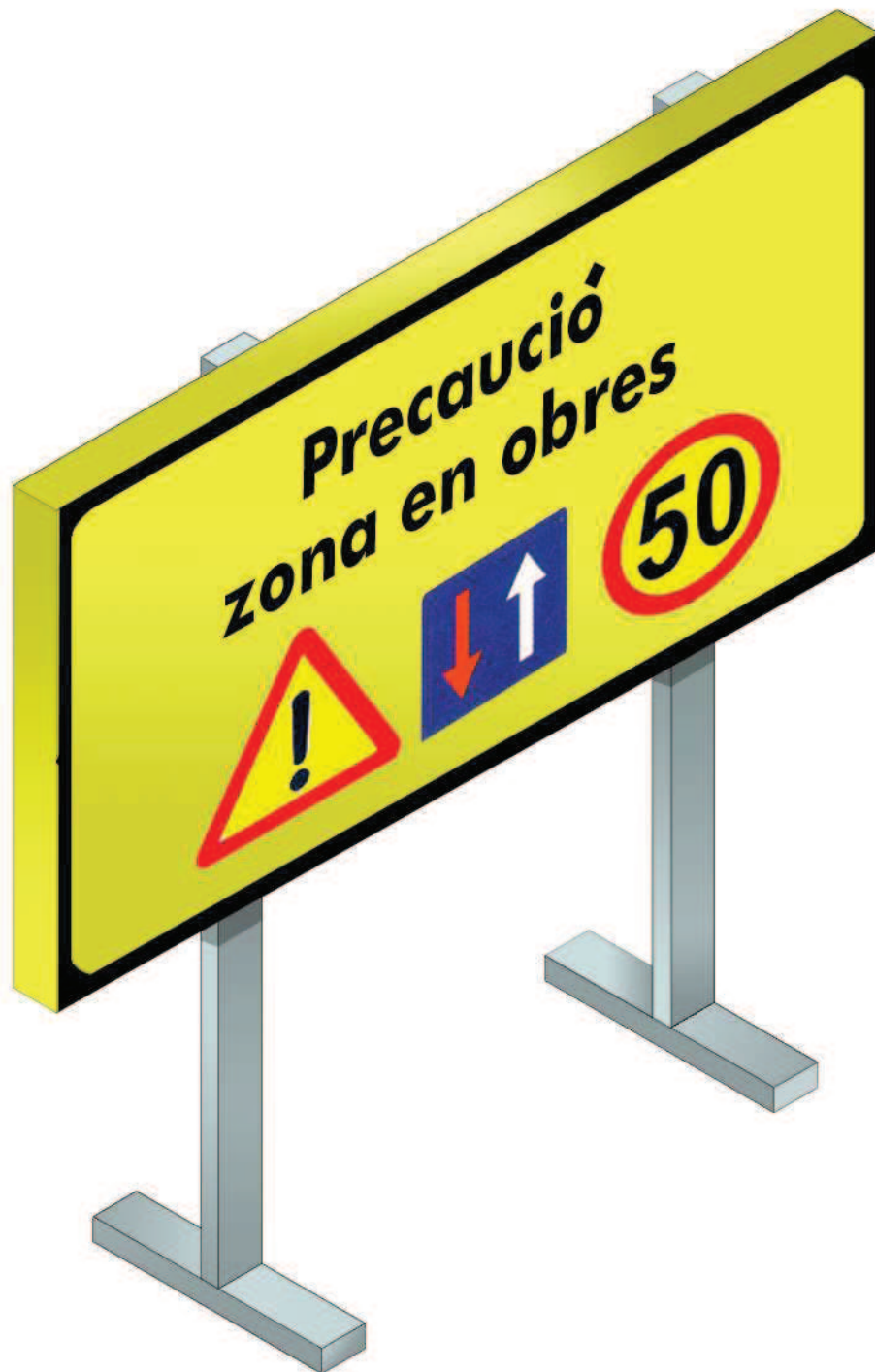
Senyalització obres: Precaució, zona en obres
