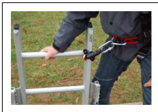
Una vez instalado en el raíl, el usuario ya está asegurado.
