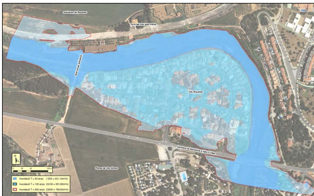
Extensió de la inundació en planta a l'àmbit d'estudi en la situació proposada per 50, 100 i 500 anys de període de retorn.
