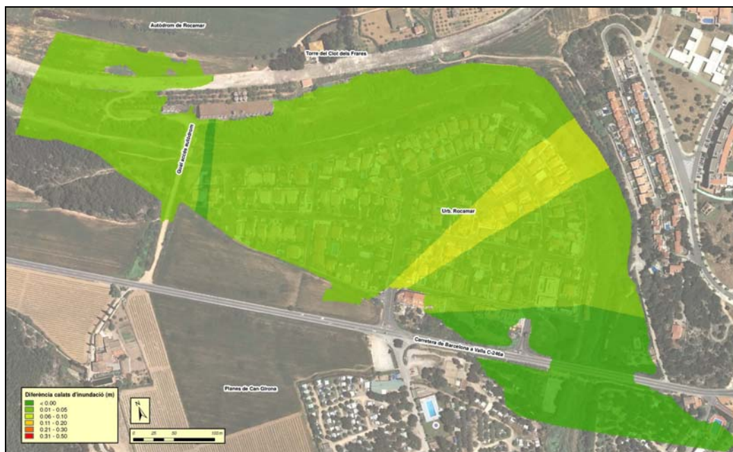
Diferència de calats d'inundació per avingudes de 500 anys de període de retorn a l'àmbit de la urbanització "Rocamar" entre la proposta d'actuacions i la situació actual.
