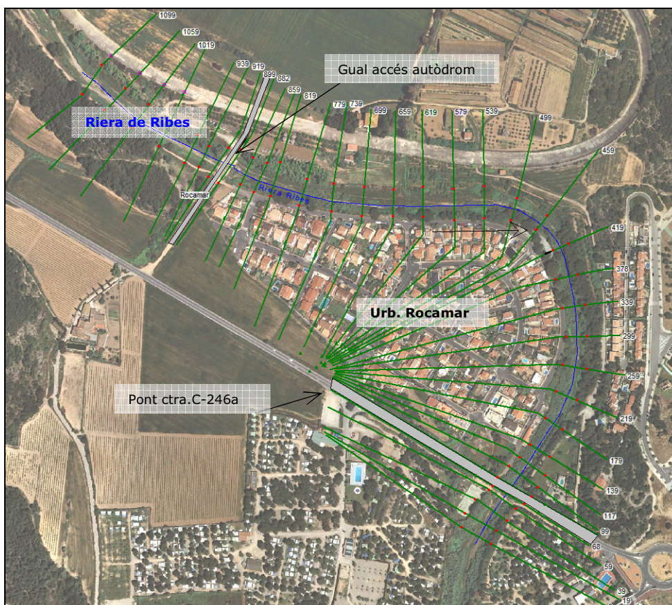
Esquema de la discretització de la modelització per a l'estat actual
